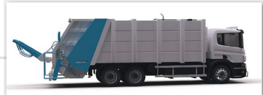
Çift kollu kaldırıcı sistemi Skip hoist system
