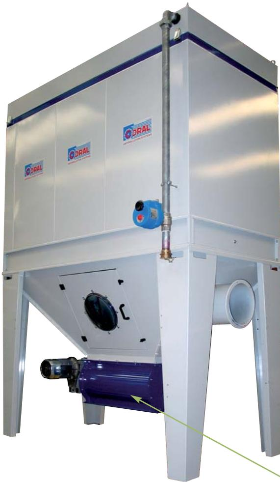
L'Eurofilter modello VS è equipaggiato con tramoggia e valvola stellare per facilitare lo scarico polveri in un contenitore più grande mobile oppure per un trasporto pneumatico ad un silos di stoccaggio. La valvola stellare è sovradimensionata per garantire un funzionamento ottimale dell'unità filtrante anche in condizioni di lavoro gravose. Inoltre la valvola stellare può essere dotata, su richiesta come optional, nella configurazione VST tale da eliminare le perdite di pressione allo scarico.
